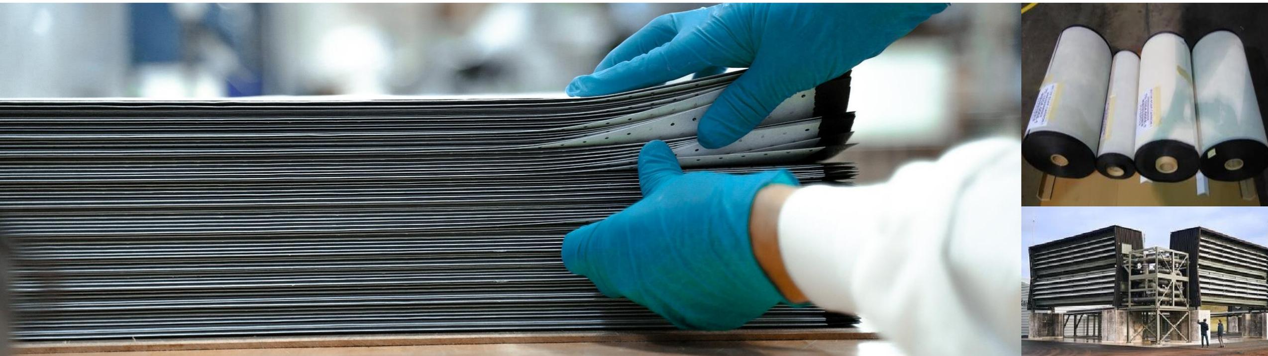
Les sorbants en rouleau 3M™ (SOAR) sont des matériaux nano-conçus conçus pour piéger le dioxyde de carbone (CO<sub>2</sub>) de l'atmosphère. Les feuilles de matériau SOAR sont empilées en couches parallèles dans les filtres à charbon actif de Svante. **3M et Svante s'associent pour développer des produits de capture directe de l'air destinés au secteur de l'élimination du dioxyde de carbone** afin d'aider le monde à atteindre des émissions nettes nulles.
